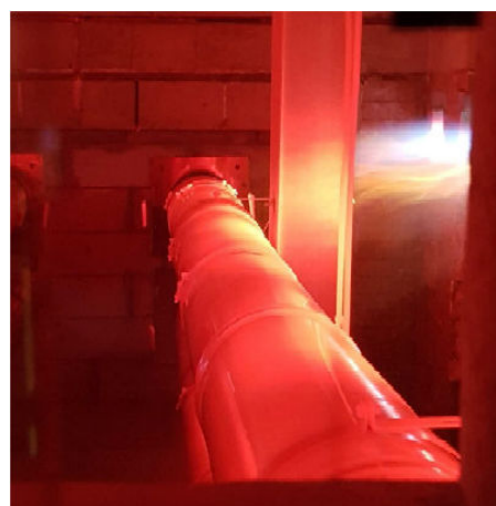
Komín - skúšobná vzorka počas skúšky
