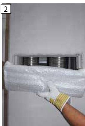
2 Z montážneho otvoru odoberte mriežku konvekčného vzduchu.
