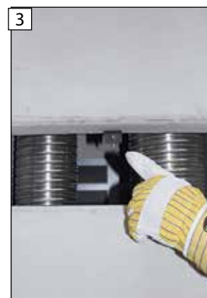
3 Detailný pohľad na prídržný uholník, spolu z výrobného podniku zaskrutkovanou poistnou skrutkou pre mriežku konvekčného vzduchu.
