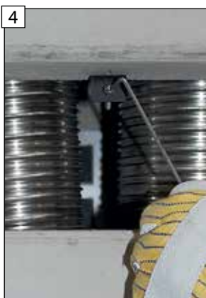
4 Vyskrutkujte poistnú skrutku pre mriežku konvekčného vzduchu.
