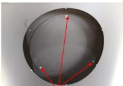
Wiercenie narzędziem o średnicy 6 mm
