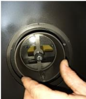
Montaż przyłącza powietrza
