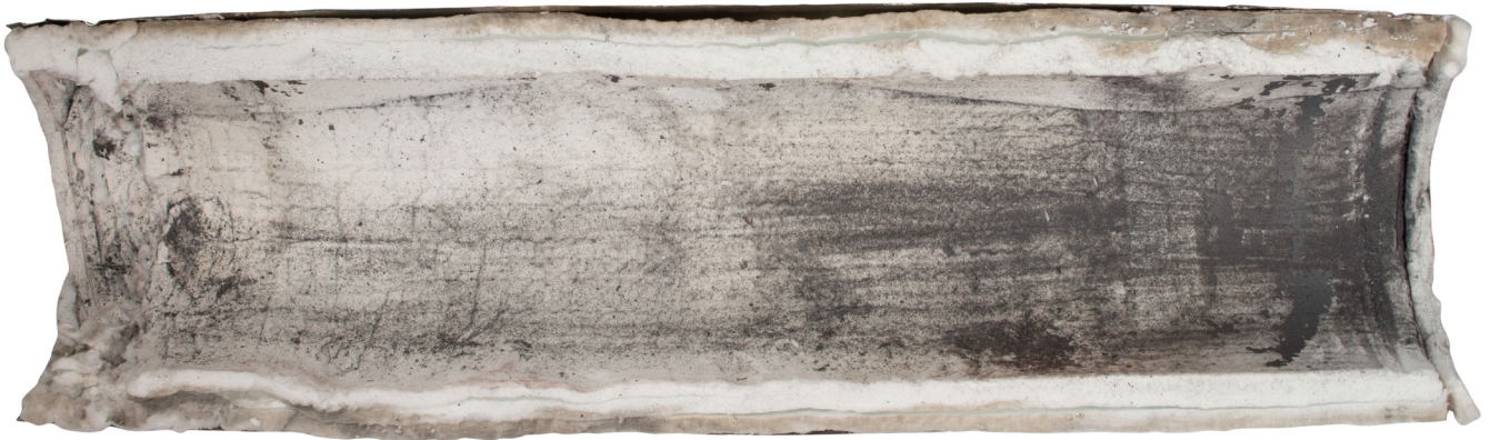
Afbeelding 4: doorsnede van Metaloterm AT meterelement met Schiedel Blanket isolatie na vier schoorsteenbrandtesten
