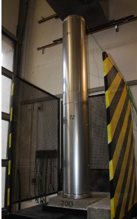
Afbeelding 1: Testopstelling schoorsteenbrandsimulatie met AT meterelementen
