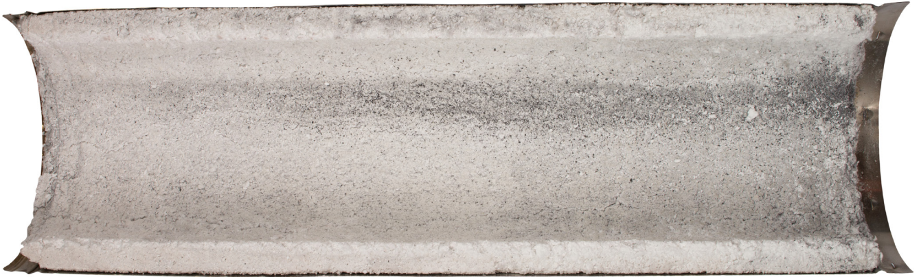
Afbeelding 3: doorsnede van Metaloterm AT meterelement met Amgiso isolatie na vier schoorsteenbrandtesten
