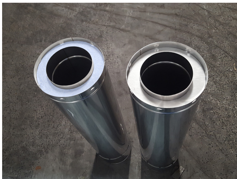
Afbeelding 2: De AT meterelementen met een lengte van 965mm van de testopstelling gevuld met Amgiso (links) en Schiedel Blanket (rechts).
