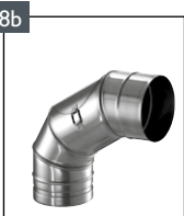
Bocht 0-90° regelbaar met reinigingsopening voor vaste brandstoffen (alleen voor onderdruk)
