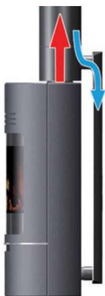
Med tilluftskanal bak ovnen
