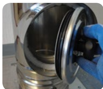
1. Uzmanību: Atkarībā no kurināmā materiāla jālieto atbilstoša iekšējā blīve.
