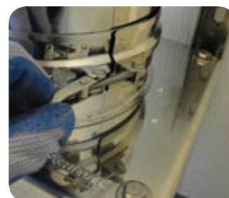
3. Uz savienojuma uzlikt skavu, aizsprādzēt un pievilkt.
