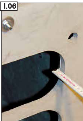
Apdares augšējās plaknes biezuma izmērīšana.
