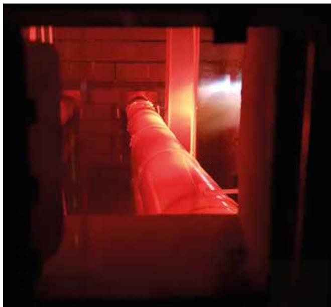
Immagini dei test di resistenza al fuoco realizzati secondo UNI EN 1366:13 sui sistemi fumari Schiedel serie ICS e ICS 5000
