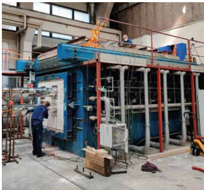
Immagini dei test di resistenza al fuoco realizzati secondo UNI EN 1366:13 sui sistemi fumari Schiedel serie ICS e ICS 5000
