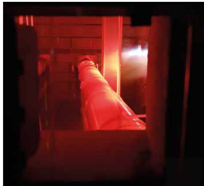
IMAGES DES TESTS DE RÉSISTANCE AU FEU RÉALISÉS SELON EN 1366:13 SUR LES CONDUITS DE FUMÉE SCHIEDEL
