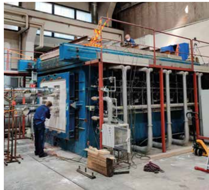
IMAGES DES TESTS DE RÉSISTANCE AU FEU RÉALISÉS SELON EN 1366:13 SUR LES CONDUITS DE FUMÉE SCHIEDEL
