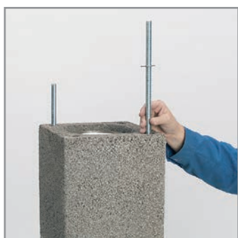
8.1 Csavarjuk össze a két-két rögzítő szárat az egy-egy fedkő rögzítő csavarral, és átlósan helyezzük két sarokfuratba.
