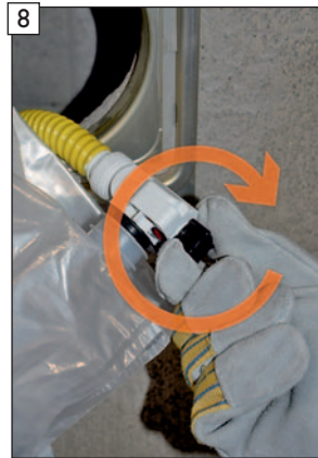
8 Verriegelung des BIB-Connectors im Uhrzeigersinn schließen.
