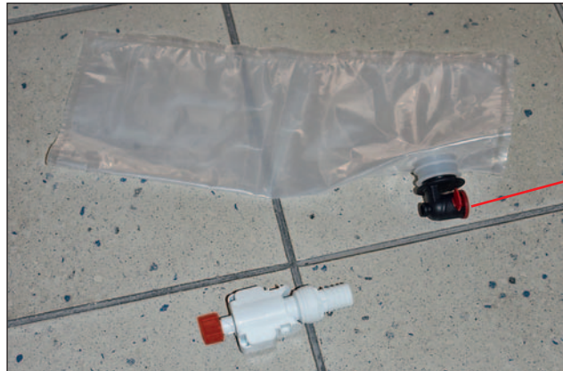
Detaildarstellung Siegelverschluss BIB-Anschlusshahn
