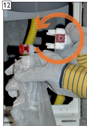
Verriegelung des BIB-Connectors (Drehung gegen den Uhrzeigersinn) öffnen und BIB-Anschlusshahn mit dem Kondensatauffangbeutel aus dem Kupplungsteil herausziehen.
