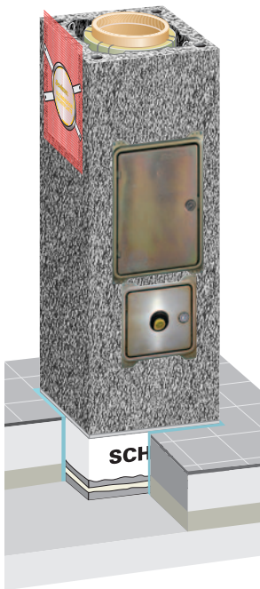
B.01 RA-Schnittschablone anlegen, Mantelsteinöffnung anzeichnen.
