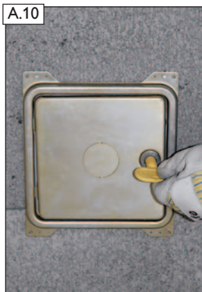
A.10 BlowerDoor Türblatt einsetzen und verschließen.
