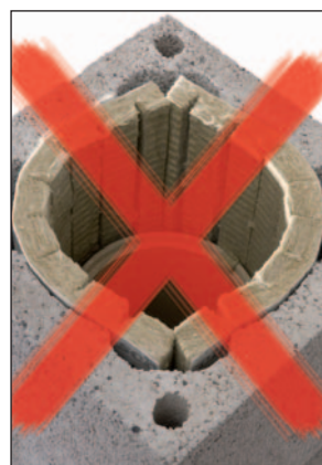
ACHTUNG! Die Hinterlüftungskanäle müssen freibleiben!
