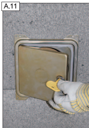
A.11 BlowerDoor Türblatt mit dem PT-Schlüssel öffnen und aushängen.
