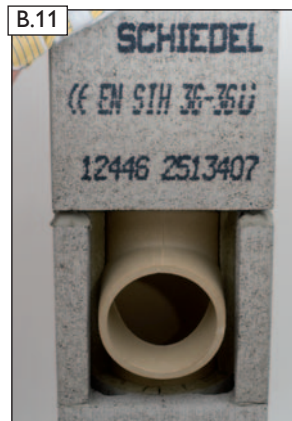
B.11 Vorgeädämten Mantel- stein in Mörtel MG(M5) Ila (Mauermörtel nach EN 998-2) versetzen.
