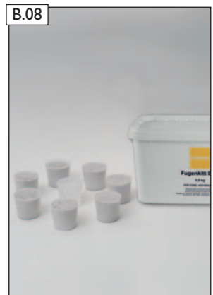
B.08 Fugenkitt anmischen. Verhältnis: 7 Teile Fugenkitt auf 1 Teil Wasser
