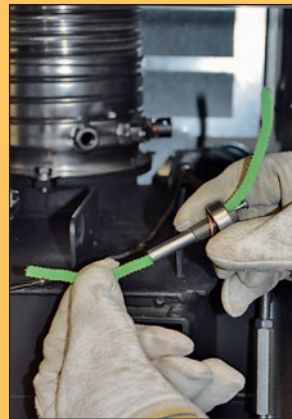
Messkanal des Verbindungselementes von innen reinigen.
