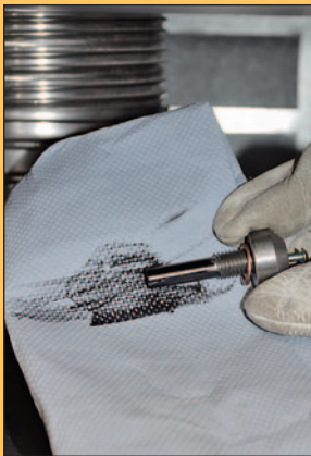
Verbindungselement von außen reinigen.
