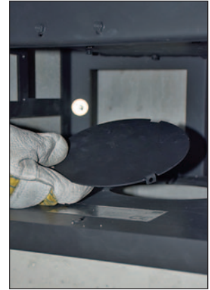
Revisionsdeckel im Geräteboden abnehmen.
