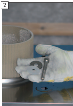
Montagereihenfolge: 1. Silikondichtungen 2. Edelstahl-Unterlegscheiben 3. Edelstahl-Inbusschrauben M12
