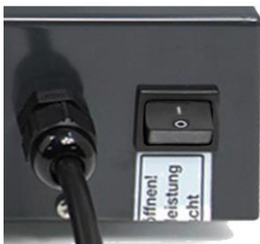
Abb. 22: Einschalten der Steuerung
