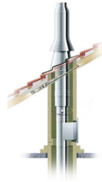
Beispiel: doppelwandiges Edelstahlelement als Verkleidung über Dach.
