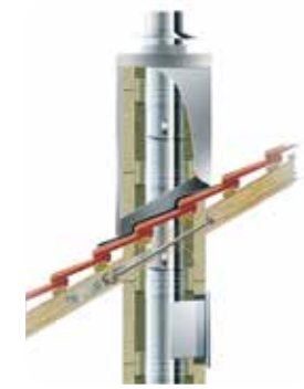
Beispiel: Stülpkopf Alu als Verkleidung über Dach.
