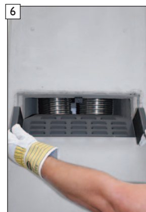
6 Sichtschutzblende schräg angestellt in die Konvek- tionsluftöffnung einstecken und dann bis zum Anschlag nach unten schieben.
