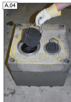
Unteren Schutzschwamm Abgas (1) in Montagetrichter einstecken.
