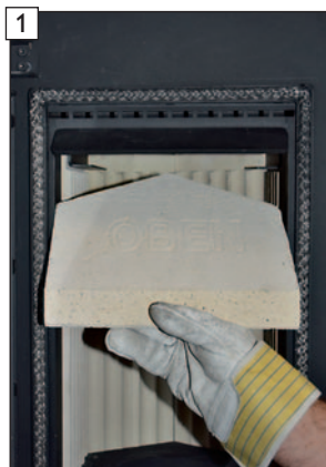
Untere Prallplatte einsetzen.
