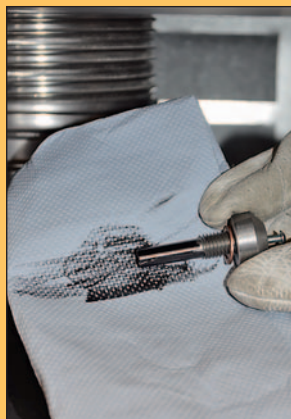
Verbindungselement von außen reinigen.
