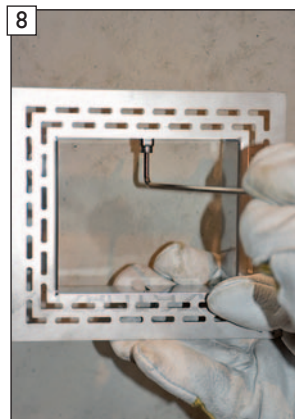
Bei Teleskopeinstellung 0-15 mm müssen die beiden Aufnahmenasen an der Displayblende entfernt werden. Die Displayeinheit rastet bei 0-15 mm in den Aufnahmenasen des LEDA LUC Kunststoffgehäuses ein.
