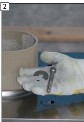
Montagereihenfolge: 1. Silikondichtungen 2. Edelstahl-Unterlegscheiben 3. Edelstahl-Inbusschrauben M12
