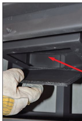
Ansicht Revisionsöffnung des Zuluftkanals an der Geräteunterseite zur Entnahme von evtl. herabfallenden Kehrresten oder Fremdkörpern aus dem Zuluftkanal.
