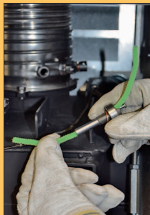
Messkanal des Verbindungselementes von innen reinigen.
