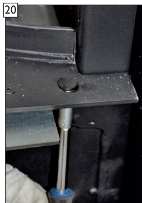
20 Verschraubung am Blindstopfen an der Bohrung des Türkontaktschalters lösen.
