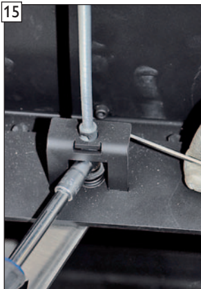
15 Befestigungsschraube an der Stellhebelhalterung lösen und entfernen.
