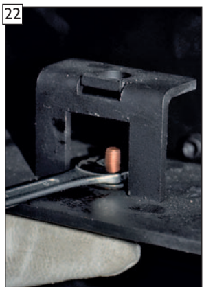
22 ... in die Stellhebelbohrung als Blindstopfen montieren.
