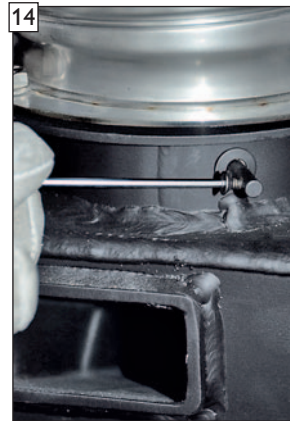
14 Befestigungsschraube wieder in die Stellhebelwelle einschrauben.
