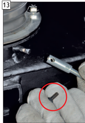
13 Befestigungsschraube der Steckhülse der Stellhebelwelle abziehen.
