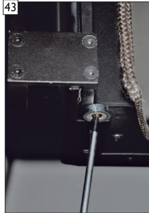
43 Türkontaktmagnet an der Unterseite der Brennkammertür befestigen.
