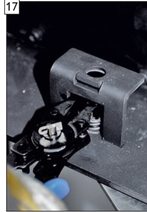
17 Sprengring vom Stellhebel mit Sprengringzange lösen.
