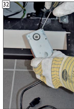
32 Befestigungsschrauben an der Stellmotorrückseite herausschrauben.
