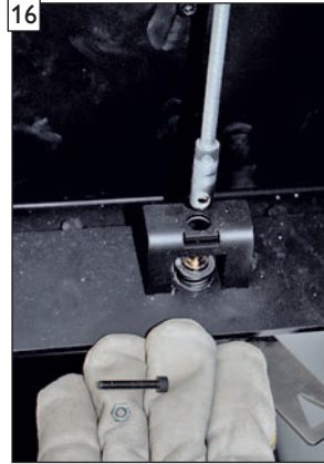
16 Stellhebelwelle kann nun entfernt werden.
