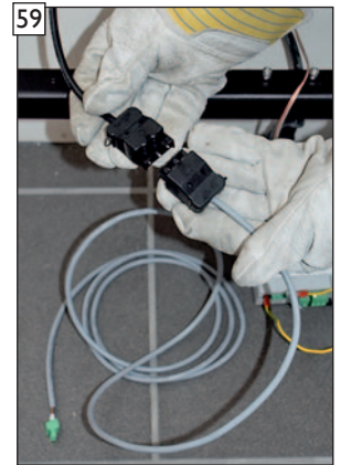
59 Anschlussstecker des Stellmotors mit dem Stecker des Stellmotor-Verbindungskabels verbinden.
