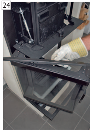
24 Obere Glashalteleiste mit den Stellhebelpositionen 1 bis 3 entfernen.
