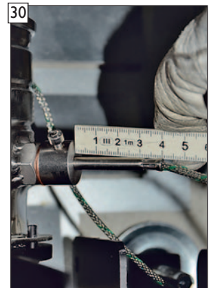
30 Abgastemperaturfühler in Anschlussklemme einstecken. WICHTIG! Restüberstand 40 mm genau einhalten!
