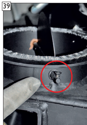
39 WICHTIG! Die Stellschraube muss zum Einbau der Stellmotorwelle senkrecht nach oben zeigen damit die Zuluftklappe beim Anschluss an den Stellmotor vollständig bis zum Anschlag geöffnet ist. (Montageansicht ohne montierter Zuluftleitung)
