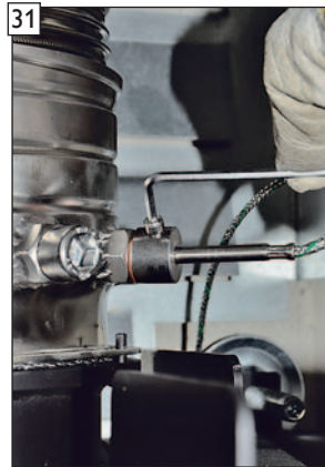
31 Abgastemperaturfühler mit Fixierschraube sichern.
