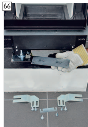
66 Klemmverbindung des Gleitlagers wieder montieren.
