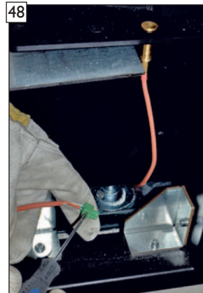
48 Anschlussstecker wieder auf Verbindungskabel montieren. HINWEIS! Polung des Anschlusssteckers ist nicht relevant!
