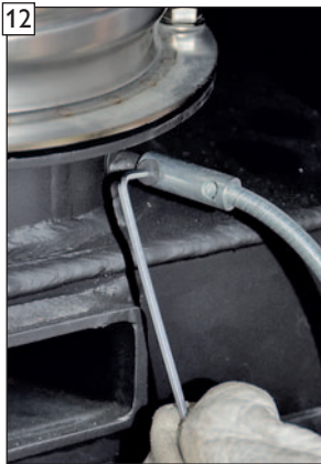
12 Befestigungsschraube der Stellhebelwelle am Zuluftadapter lösen und entfernen.
