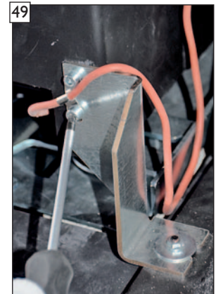
49 Zugentlastung für Verbindungskabel montieren.
