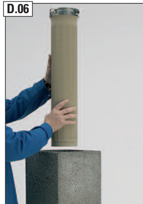
D.06 Profilrohr (L=66 cm) einsetzen.
