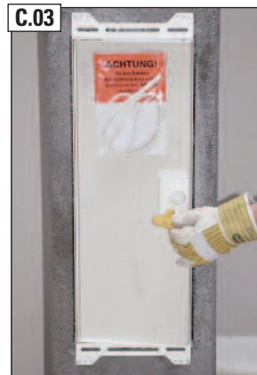
... entriegeln dann die BlowerDoor-Design-Fertigfußtür mit dem PT-Schlüssel.
