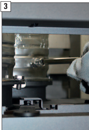
3 Edelstahlverschluss- schraube M12 am Mess- fühlerstutzen des Abgasadapters lösen ...
