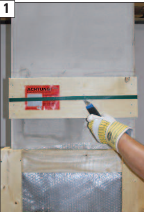
Äußere Transportschutzverpackung entfernen.
