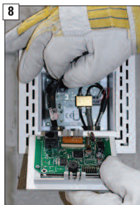
Steckverbindung mit der LUC-Displayeinheit verbinden.
