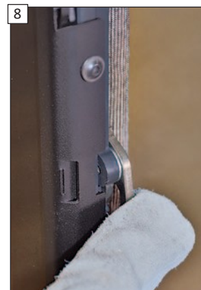
8 Před demontáží posuňte dveřní západku do uzavřené polohy.
