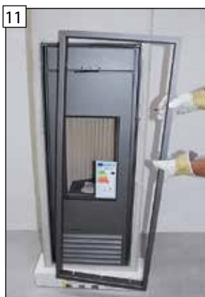
11 Namontujte montážní rám. POZOR! Podle polohy upevňovacích šroubů vytvořte správnou polohu pro montáž!
