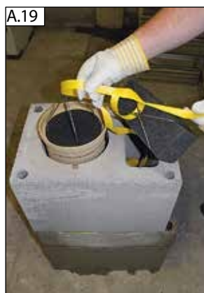
Vnitřní konec z cívky lana pevně svažte dvojitým uzlem se spodní částí vrchního dílu pro odvod spalin. 4).
