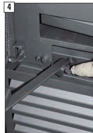
4 Aretace dveří topeniště.
